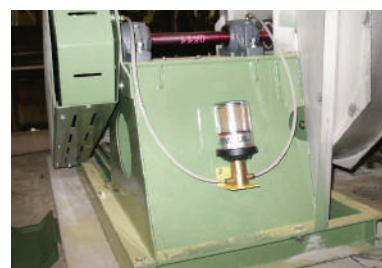
Industria alimentaria: lubricación de cojinetes de ventilador de la marca Solyvent Ventec.
