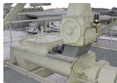
Industria del sector minero: cementera, lubricación de 4 rodamientos del tornillo sinfín de la entrada de cal.
